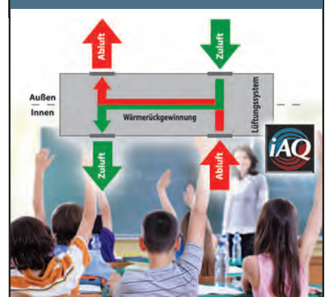
iAQ-integriertes Lüftungssystem (AHU)
