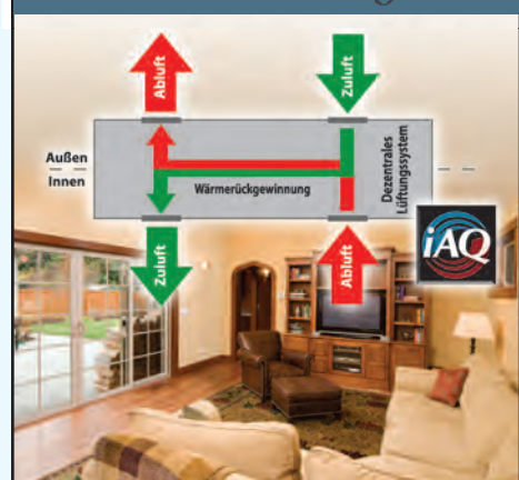
iAQ-integriertes dezentrales Lüftungssystem
